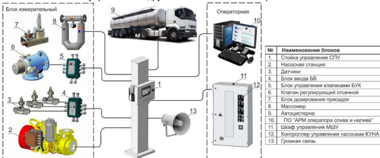
Рис. 13 - Взаимодействие стойки управления (СПУ) с компонентами измерительной системы
